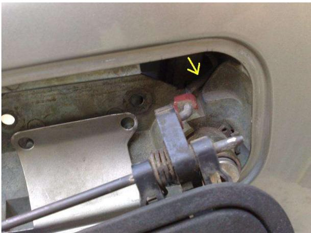
A la hora de montar el tirador exterior, primero colocar correctamente la chapa interna y luego se mete la varilla del tirador por donde está la flecha. Encajar la punta de plástico en el sitio del cierre y atornillar las tuercas.
