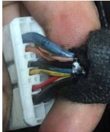
Conector 2 que se conecta en el autoestereo
