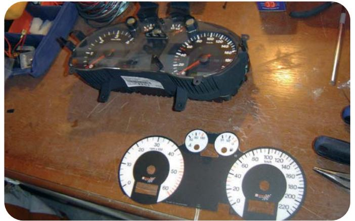
Con el cuadro según la foto ya solo quedara desmontarle la carcasa que como veremos esta sujeta por unas pestañas, por lo que tendremos q ir haciendo palanca con un destornillador plano para desencajar todas las pestañas de la carcasa.
