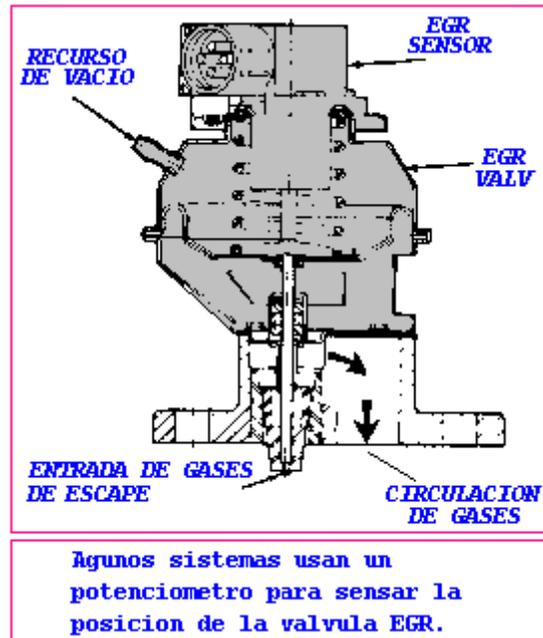
Este sensor monitorea, la posicion de la valvula EGR, y el PCM usa esta señal para que con exactitud controle el flujo de vacio a los selenoidces que regulan esta valvula, usualmente, el voltage del EVP sera de 1 voltio con la llave abierta y el motor apagado, y sobre 4.6 voltios a un flujo maximo, esta informacion puede ser observada en un Scan Tool de la siguiente manera:
