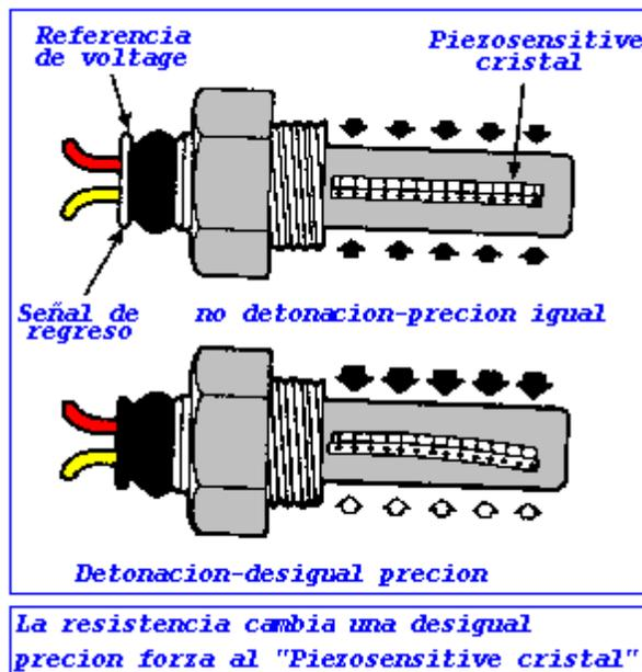
El PCM usa esta señal, para atrasar el tiempo cuando hay una condicion de detonacion ( cascabeleo ), esta lectura puede ser observada en un Scan Tool de la siguiente manera:
