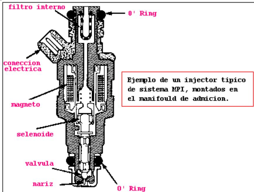
Cuando un inyector recibe corriente electrica, una armadura integral y una pequeña ahuja que se mueven una corta distancia contra un resorte para abrir una pequeño orificio, un constante voltage es aplicado al inyector y el PCM envia una señal de tierra para energizar el inyector.
