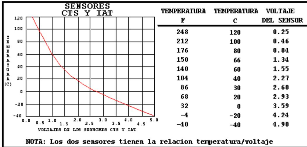
Tabla de operacion de los sensores de los sensores de temperatura CTS Y IAT (Coolant Temperatura Sensor y Intake Absolute temperature)
