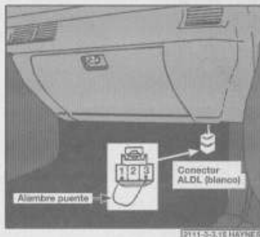
7.15 Ubicación del conector de diagnóstico, debajo del tablero en el lado de pasajero
